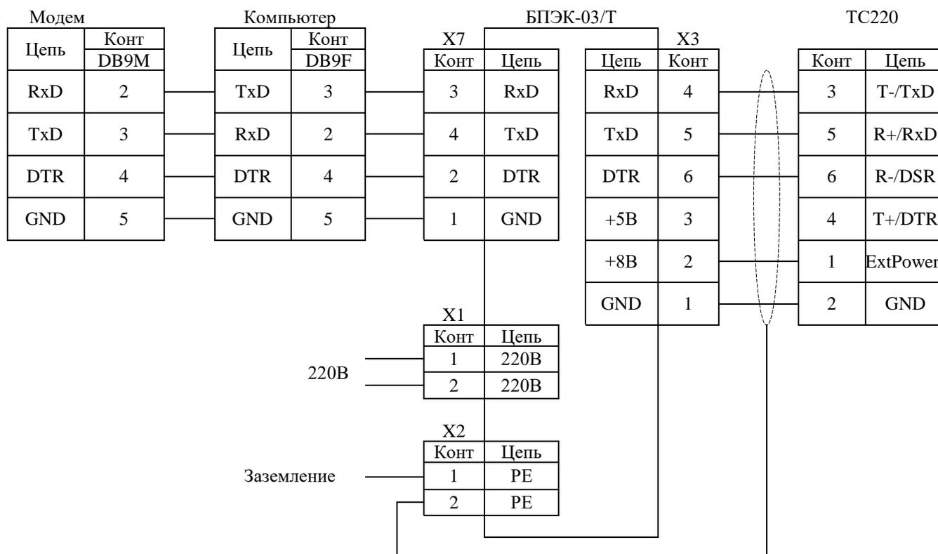
Рисунок 2. Пример схемы внешних соединений БПЭК-03/Т с корректором TC220
