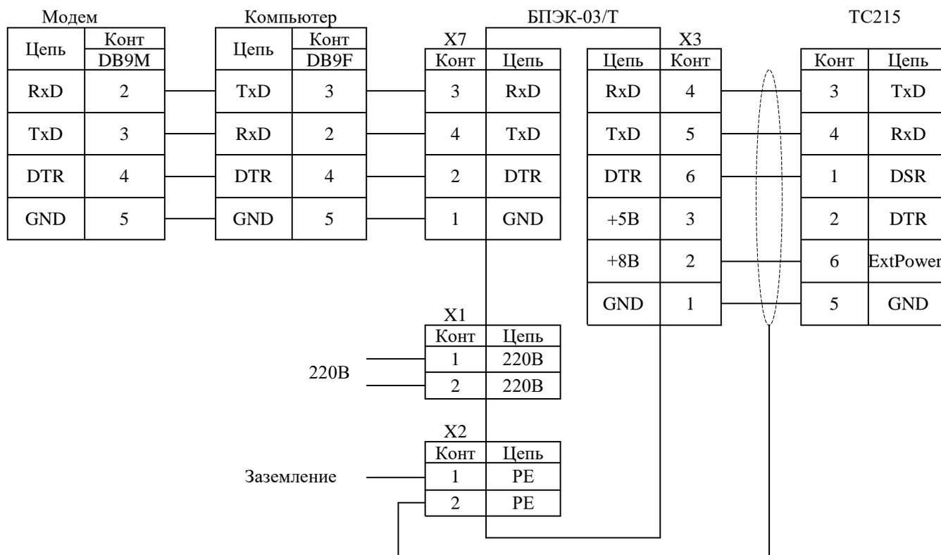
Рисунок 1. Пример схемы внешних соединений БПЭК-03/Т с корректором TC215.
