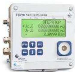
Корректоры объема газа предназначены для измерения объема неагрессивного сухого природного или попутно-нефтяного газа, приведенного к стандартным условиям путем измерения объема газа при рабочих условиях счетчиками газа турбинными (TRZ, СГ), ротационными (РАВО, RVG) и автоматической электронной коррекции по измеренным значениям температуры и давления газа и вычисленному значению коэффициента сжимаемости. Корректоры имеют архивы и могут передавать данные в системы телеметрии.
